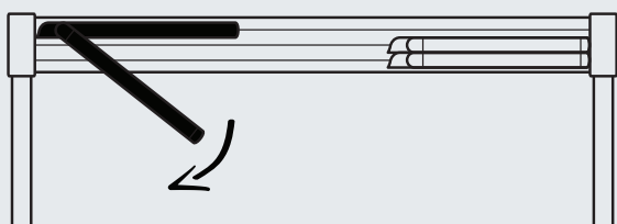
3. Løft opp håndtaket og åpne luken helt mot deg.
