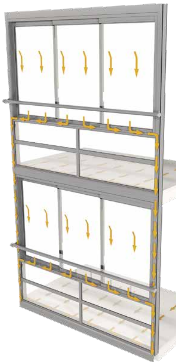
Dreneringsbull i nedre skinneprofil
